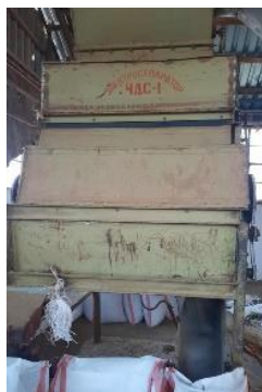
До модернизации: устаревшая линия подготовки оголенных посевных семян хлопчатника
