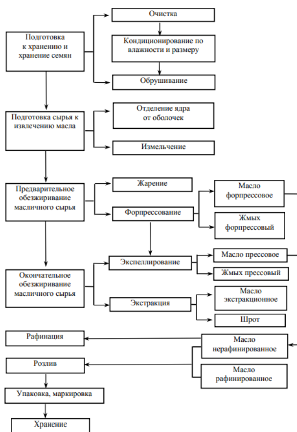
Рис. 1. Схема производства касторового масла из семян клещевины
