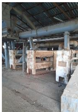
До модернизации: устаревшая линия подготовки оголенных посевных семян хлопчатника
