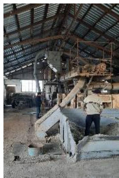
До модернизации: устаревшая линия подготовки оголенных посевных семян хлопчатника
