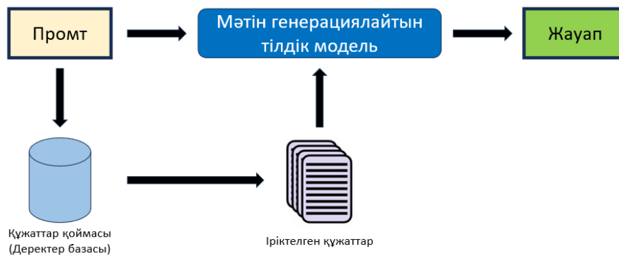
Сурет 2 – RAG моделінің кәсіпорынның электрондық құжат айналым жүйелеріндегі жұмыс істеу схемасы
