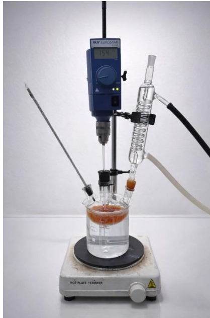
Сурет 1. Крахмал негізді биоыдырайтын полимер алу қондырғысы.
