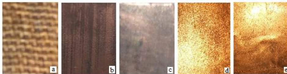
5-сурет. Мыс қабықшамен қапталған диэлектрлі материалдар: а – мақта-мата үлгісі, b – ПВХ материалы, c – пластмасса үлгісі, d – шыны үлгі, e – керамика үлгі
