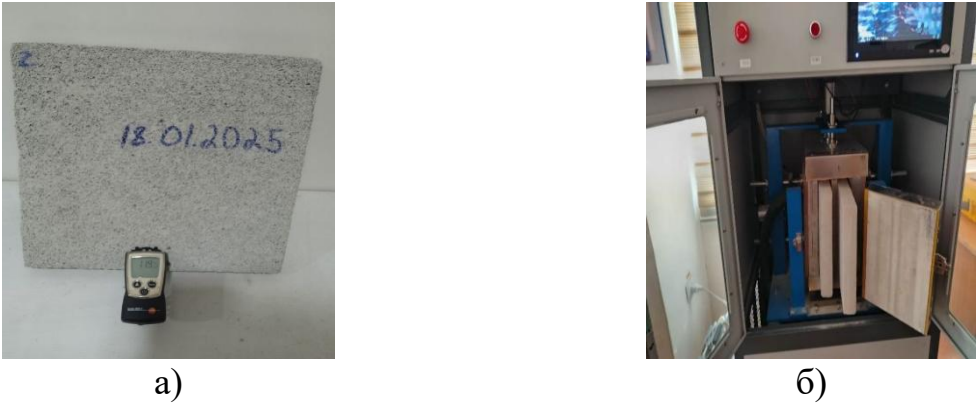
1-рисунок. а) приготовление образцов газобетона; определение влажности образцов, подготовленных для определения коэффициента теплопроводности; б) процесс испытания образца на оборудование XND-2-3030C.
