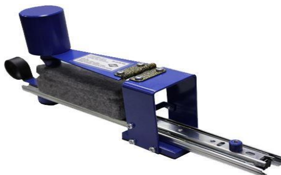
Рис. 4. Крокметр для испытания стойкости окраски ткани.
