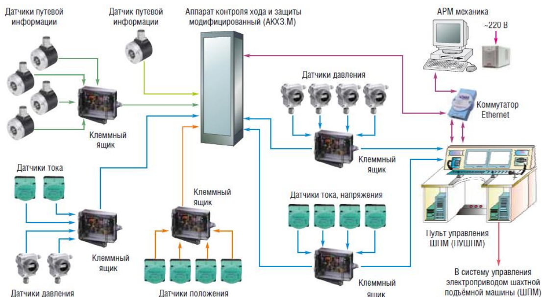
Рисунок 1. Структура и состав системы автоматизации шахтного подъемника
