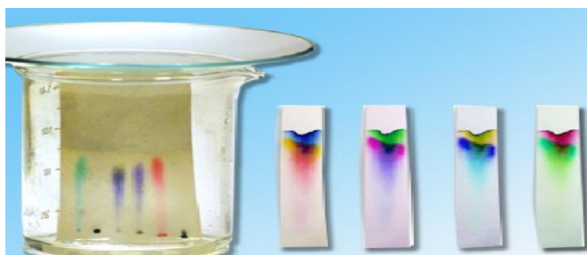
Сурет 1 - Жұқа қабатты хроматографиялық әдістер
