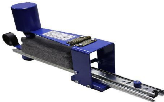
Рис. 4. Крокметр для испытания стойкости окраски ткани.
