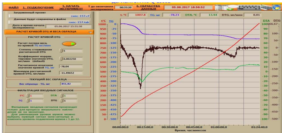
Сурет 3 - Температура 95°C алынған гипс- \text{CaSO}_4 \cdot 0,5\text{H}_2\text{O} ДТА талдауы
