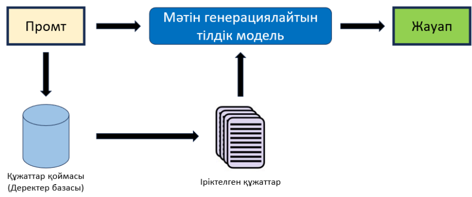
Сурет 2 – RAG моделінің кәсіпорынның электрондық құжат айналым жүйелеріндегі жұмыс істеу схемасы
